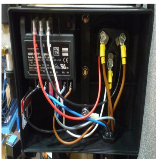
Рис 15: Правильное подключение клеммной коробки IP54 с помощью кабельных муфт (ZF33KVE)
